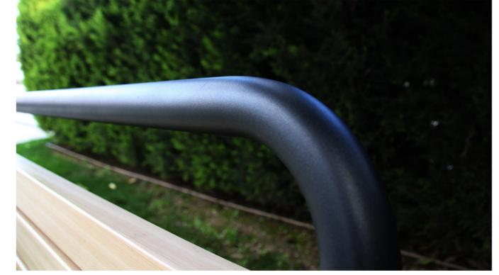
**METAL / METAL** Metal borular ve diğer metal parçalar ST 37 çelikten oluşmaktadır. Kumlama sonrası solvent içermeyen çinko-astar kaplama ve boya uygulaması ile her türlü koşulunda korozyon koruması ve UV dayanıklılığı elde edilmektedir
